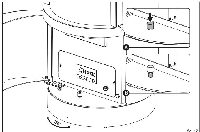
Per riportare la stufa nella posizione di partenza, ruotare la stufa a legna fino a quando le tacche sono sovrapposte (figura 13):
