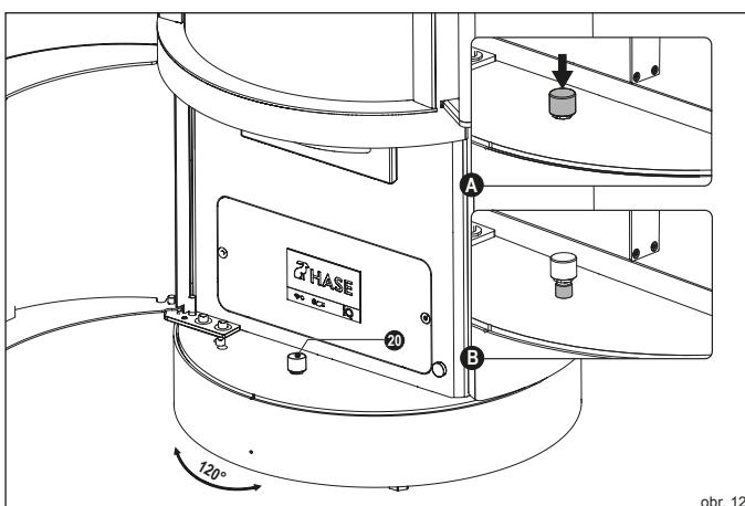
K přestavení kamen opět do výchozí polohy otočte krbová kamna tak, aby se zářezy překryvaly (obr. 13):
