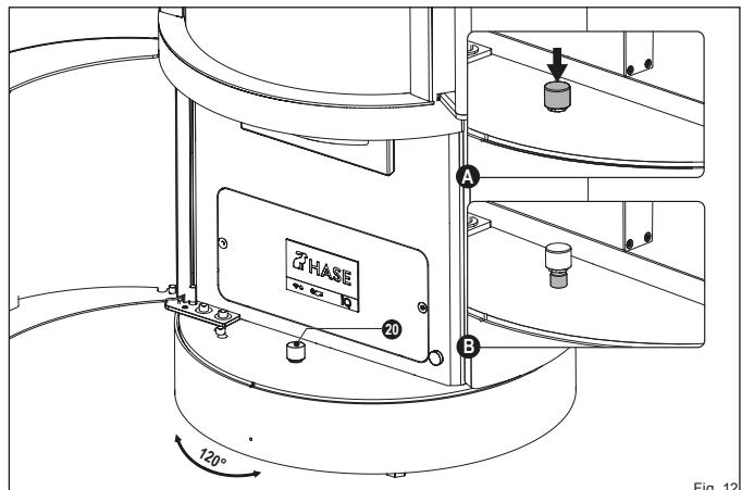
Pour remettre le poêle dans sa position initiale, faites-le pivoter jusqu'à ce que les encoches soient alignées (Fig. 13) :
